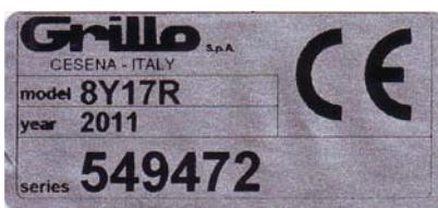
Le Grillo CL 75 est muni d'une plaquette avec le numéro de série de la machine. Cette plaquette se trouve sur la base du moteur.
