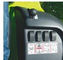
La console de droite reçoit le levier d'accélération et les commandes électriques du plateau (hauteur de coupe et relevage) et des mouvements du bac (montée/descente, ouverture/fermeture). Rien du côté gauche, si ce n'est le bouchon du réservoir de carburant.
