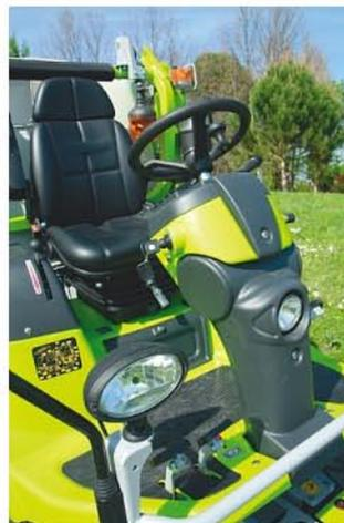
Le siège suspendu se règle d'avant en arrière. La colonne de direction s'incline via une manette placée à gauche. L'arceau Rops repliable facilite le travail dans les jardins arborés.
