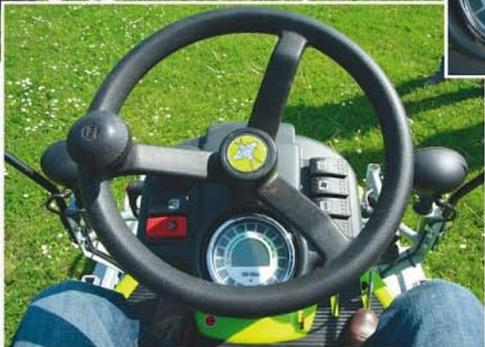
Le tableau de bord est clair: toutes les informations sont regroupées au niveau du cadran circulaire (en médaillon). À droite sous le volant, les boutons de feux, d'inversion du ventilateur, de blocage du différentiel et d'embrayage (rotor et lames). La poignée sur le volant se montre utile pour les manœuvres de précision.
