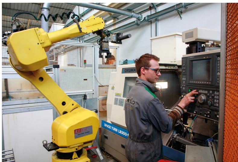
Des machines-outils entièrement robotisées se chargent d'usiner les pièces les plus complexes.
