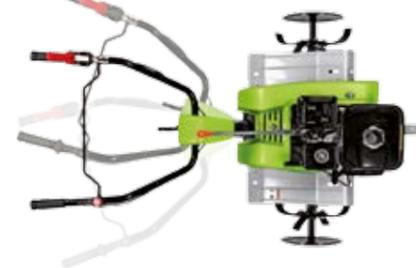
La **largeur de travail est de 97 cm** et permet un bêchage jusqu'à 33 cm. Elle est composée par 6 fraises avec disques latéraux. Les couteaux sont en acier trempé et fixés par des boulons. L'arbre de la fraise est **hexagonale de 27 mm** de diamètre.
