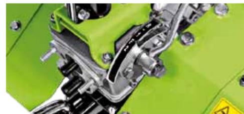
La **béquille** est réglable en hauteur sur 8 positions et basculante.
