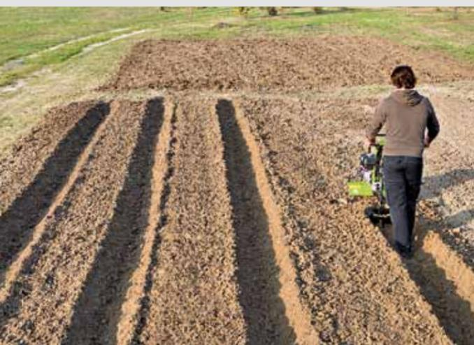
Sur un **terrain très dur** nous conseillons de démonter les disques latéraux et de renverser la béquille. Pour un rayon de braquage encore plus étroit on peut supprimer le système basculant de la béquille. (3500 et 11500).
