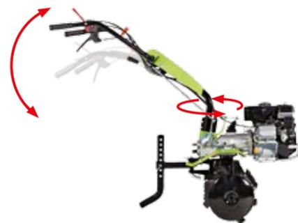
La machine est équipée avec **deux prises de force**: celle en haut, avec arbre cannelé 11 UNI 221, a une rotation antihoraire et liée directement au moteur tandis que celle en bas avec arbre cannelé 13 UNI 221 est synchronisée avec la boîte.
