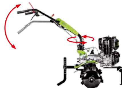
La machine est équipée avec **deux prises de force**: celle en haut, avec arbre cannelé 11 UNI 221, à une rotation antihoraire et liée directement au moteur tandis que celle en bas avec arbre cannelé 13 UNI 221 est synchronisée avec la boîte.
