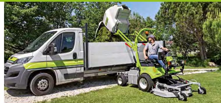
Les commandes des services hydrauliques (bac et coupe) s'effectuent par des leviers spéciaux et ergonomiques à coté du poste de conduite: un système de sécurité empêche le mouvement des leviers en cas des touches accidentelles. Grâce aux vérins hydrauliques la vidange du bac et le soulèvement de la coupe pour passer les bordures sont très faciles et rapides.
