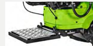
Pour aider les déplacements rapides, le **Dumper 507** peut recevoir, en option, un support conducteur. Cette plateforme est amortie et confortable: à utiliser uniquement avec la benne chargée et en condition de sécurité. Dans tous les autres cas, elle doit être pliée et reste, donc, verrouillée sans déranger l'opérateur.
