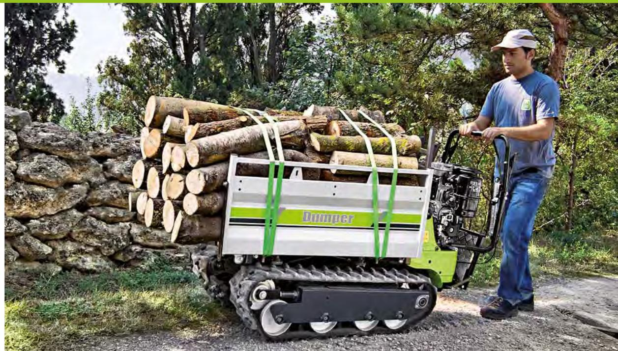
**La benne Dumper** a une capacité de 230 lt et demande obligatoirement le basculement hydraulique. La porte antérieure de cette benne s'ouvre et se ferme automatiquement au renversement. En plus, grâce à deux pieds réglables intégrés directement dans la benne, on peut aisément le démonter. Un seul opérateur est capable de gérer toutes ces manœuvres sans trop d'effort.
