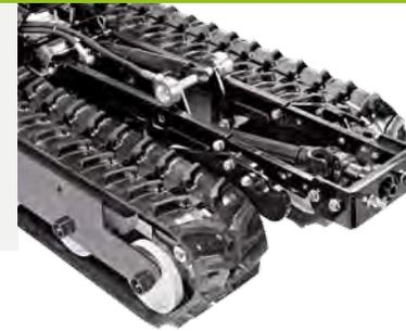
Kit relevage hydraulique avec prise de force mécanique antérieure indépendante à 965 tr/min.
