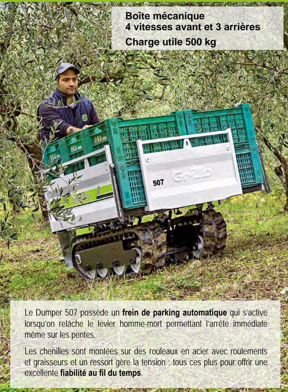
Le Dumper 507 possède un **frein de parking automatique** qui s'active lorsqu'on relâche le levier homme-mort permettant l'arrêt immédiat même sur les pentes.
