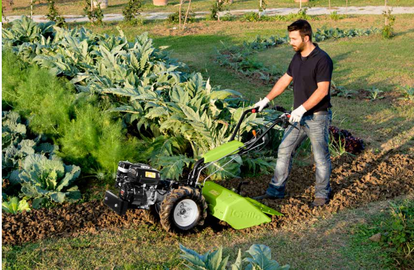
G 84 avec buttoir derrière la fraise
