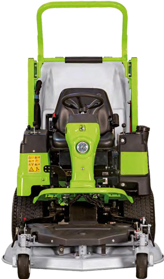
La FD 500 est équipée d'un moteur diesel Kubota 722 3 cylindres de 18 HP, conforme aux normes EC (NRMM) STAGE V (Europe) et EPA Final Tier 4 (USA), monté sur silentblocs et protégé par un châssis monocoque particulièrement robuste et spécialement conçu pour envelopper les organes principaux.
