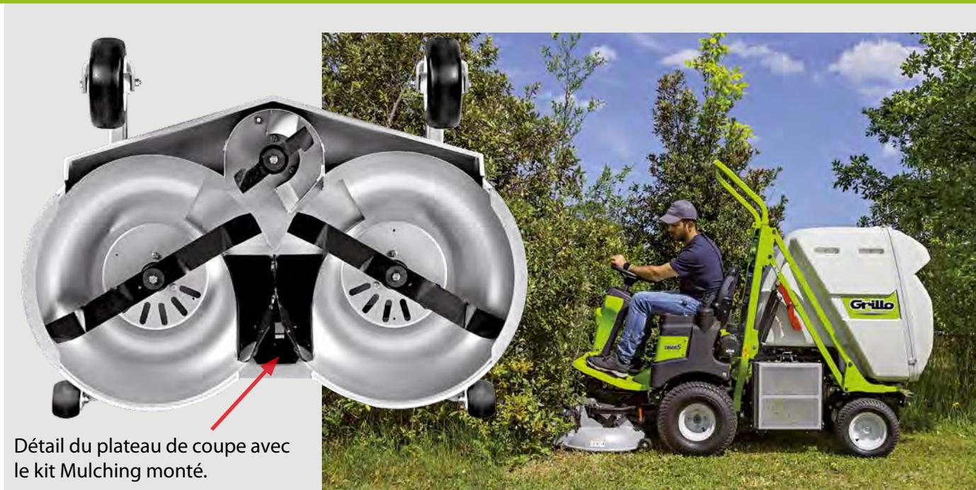
Détail du plateau de coupe avec le kit Mulching monté.
