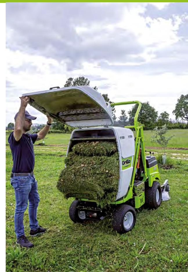
Les commandes hydrauliques de relevage et basculement du bac se trouvent à côté du siège : grâce à des leviers ergonomiques, l'opérateur peut rapidement et facilement effectuer toutes ces manœuvres. Un troisième levier permet de soulever hydrauliquement le plateau pour se déplacer ou franchir aisément les obstacles.
